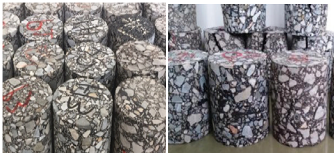
图3 单轴贯入和无侧限抗压试验试件
